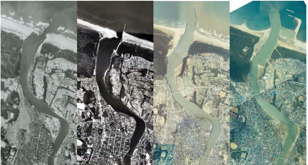
子吉川の河口工事は、昭和 24 年より開始された。現在の導流堤は、右岸側は昭和 43 年から 7 年間かけて、左岸側は昭和 56 年から 6 年間かけて建設されたものである。右岸導流堤の延長は 322m、左岸導流堤の延長は 240m に達する。
