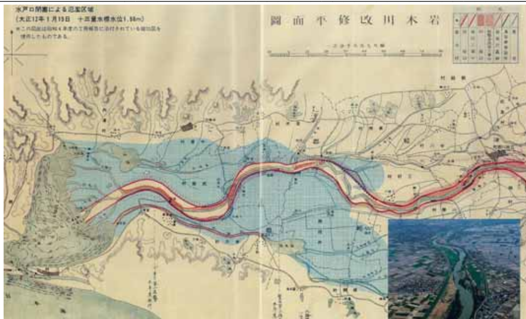
図 4-3 水戸口閉塞による氾濫区域
