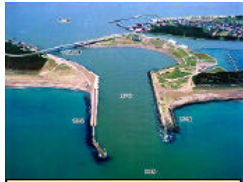
導流堤による水戸口 (河口部)の維持
