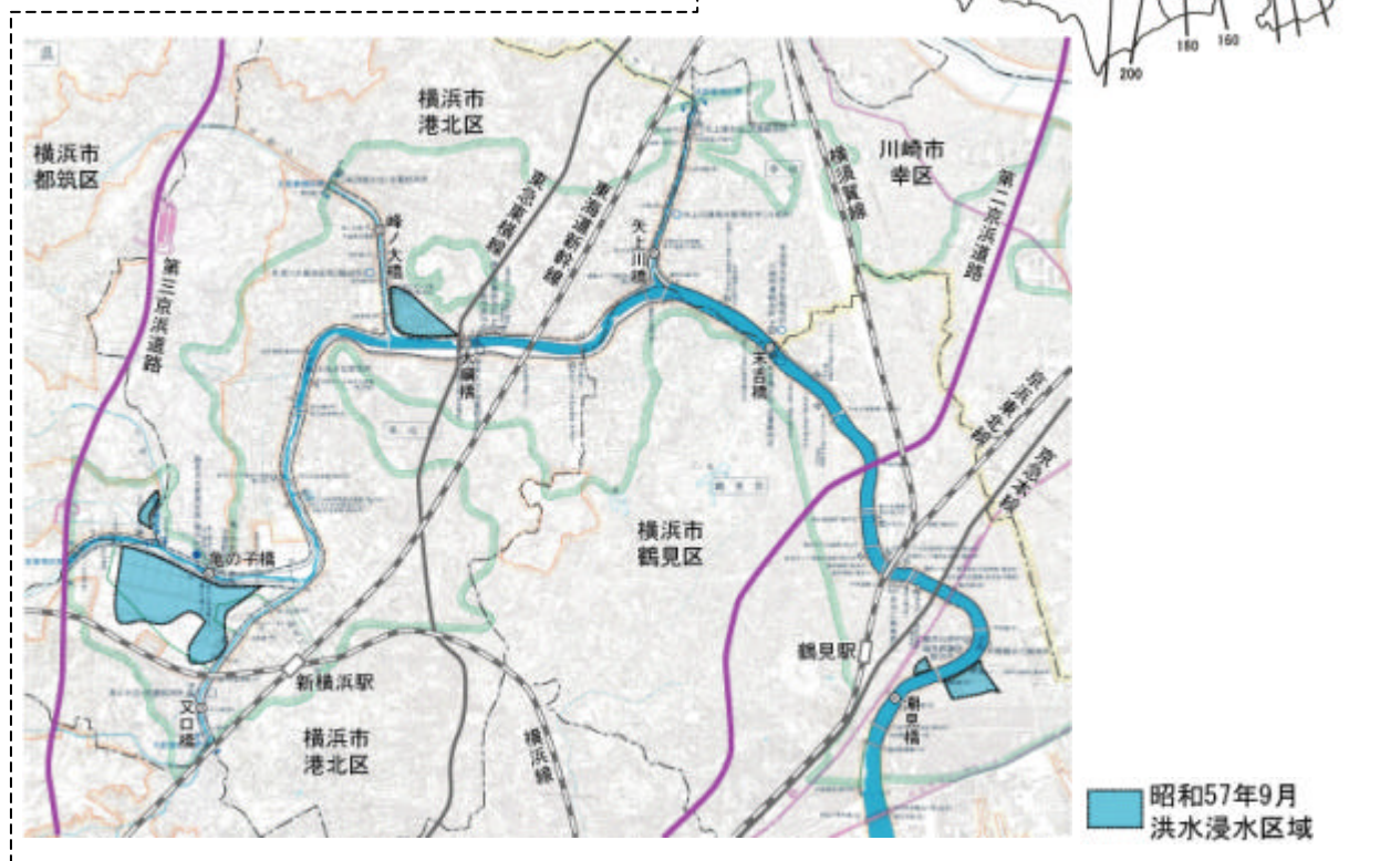
図 4-2-4 昭和 57 年 9 月洪水 — 総雨量等雨量線図と洪水浸水区域図— 出典：鶴見川流域誌／河川編、京浜河川事務所
