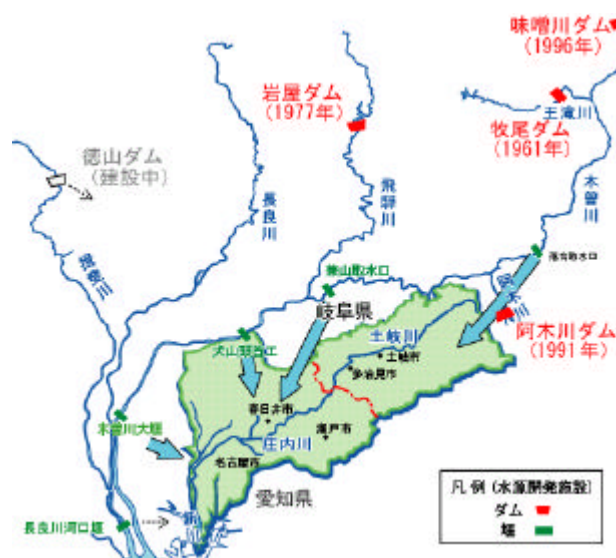
図-5.1 木曽川からの水供給模式図
