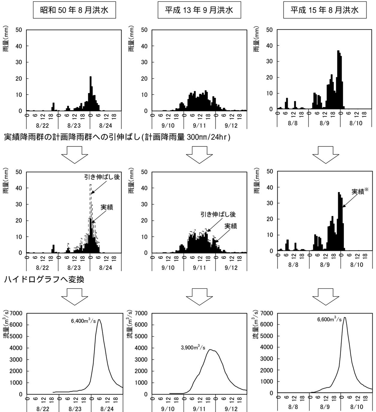
降雨の引き下げはおこなわないものとし、平成15年8月洪水は実績雨量307.4mm/24hrで流出計算
