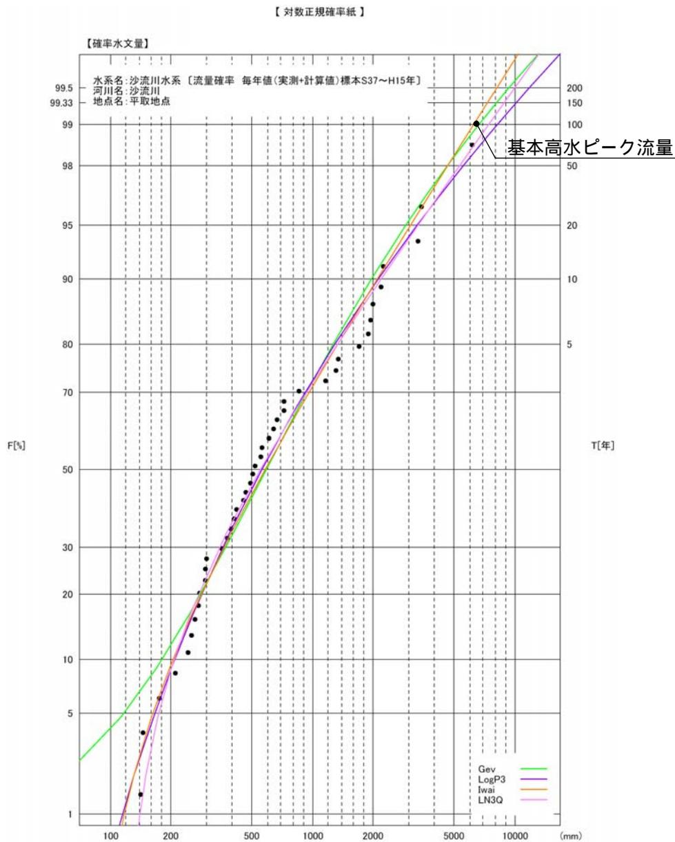
図 4-6 平取地点流量確率計算結果図
