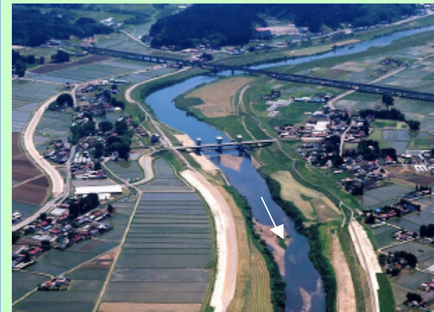
桑折江堰 (H15完成) 河床安定と農業用水の確保を目的に設置 ＊農水省との共同事業により建設
