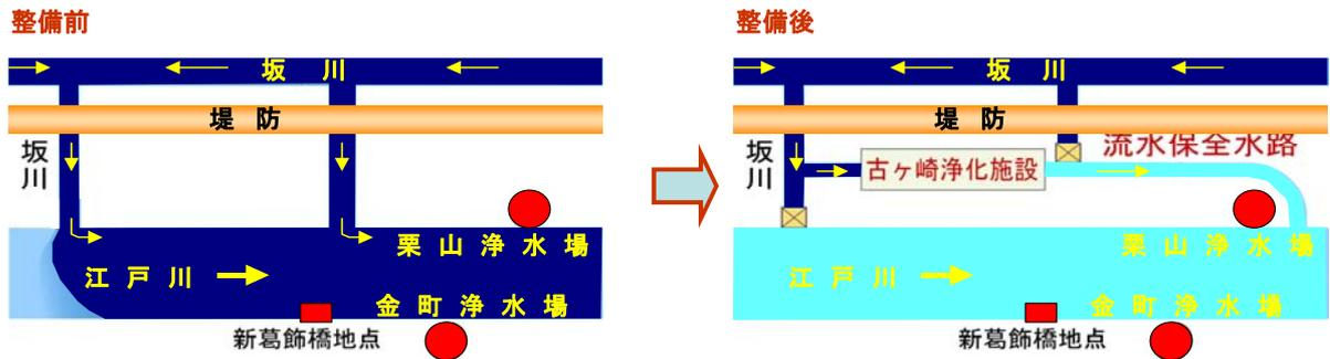
写真 6-1 浄化施設及び流水保全水路の概要
