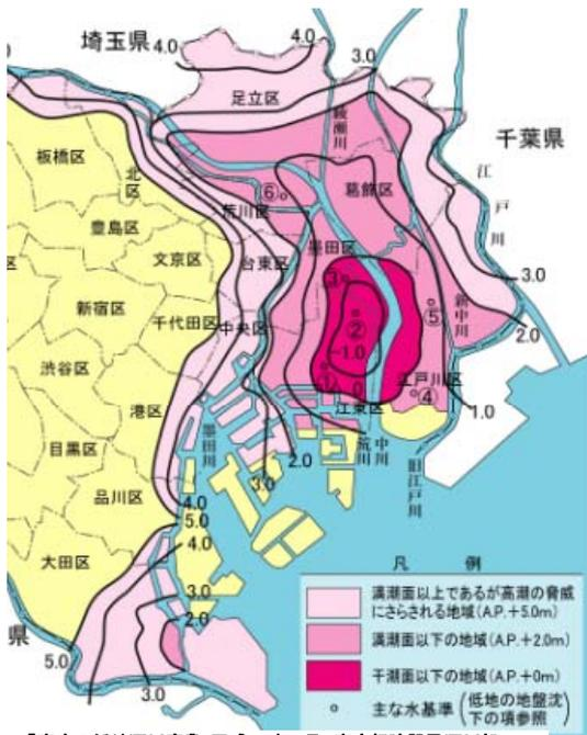
図 5-6 東京東部の低地帯の地盤高平面図
