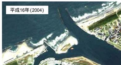
・導流堤により河口閉塞は生じていない。
