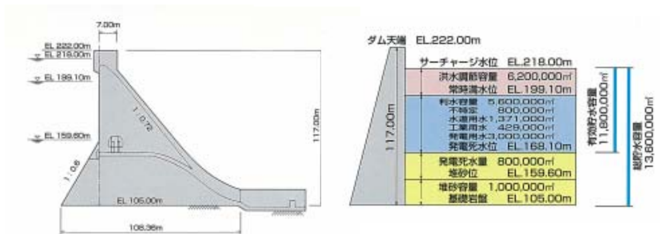
【厳木ダム模式図（標準断面図・容量配分図）】
