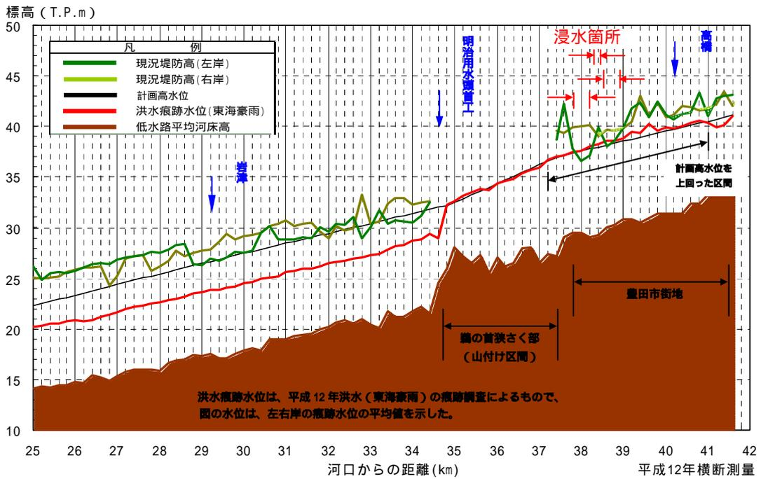
図 4-8 東海（恵南）豪雨時の水位縦断面図
