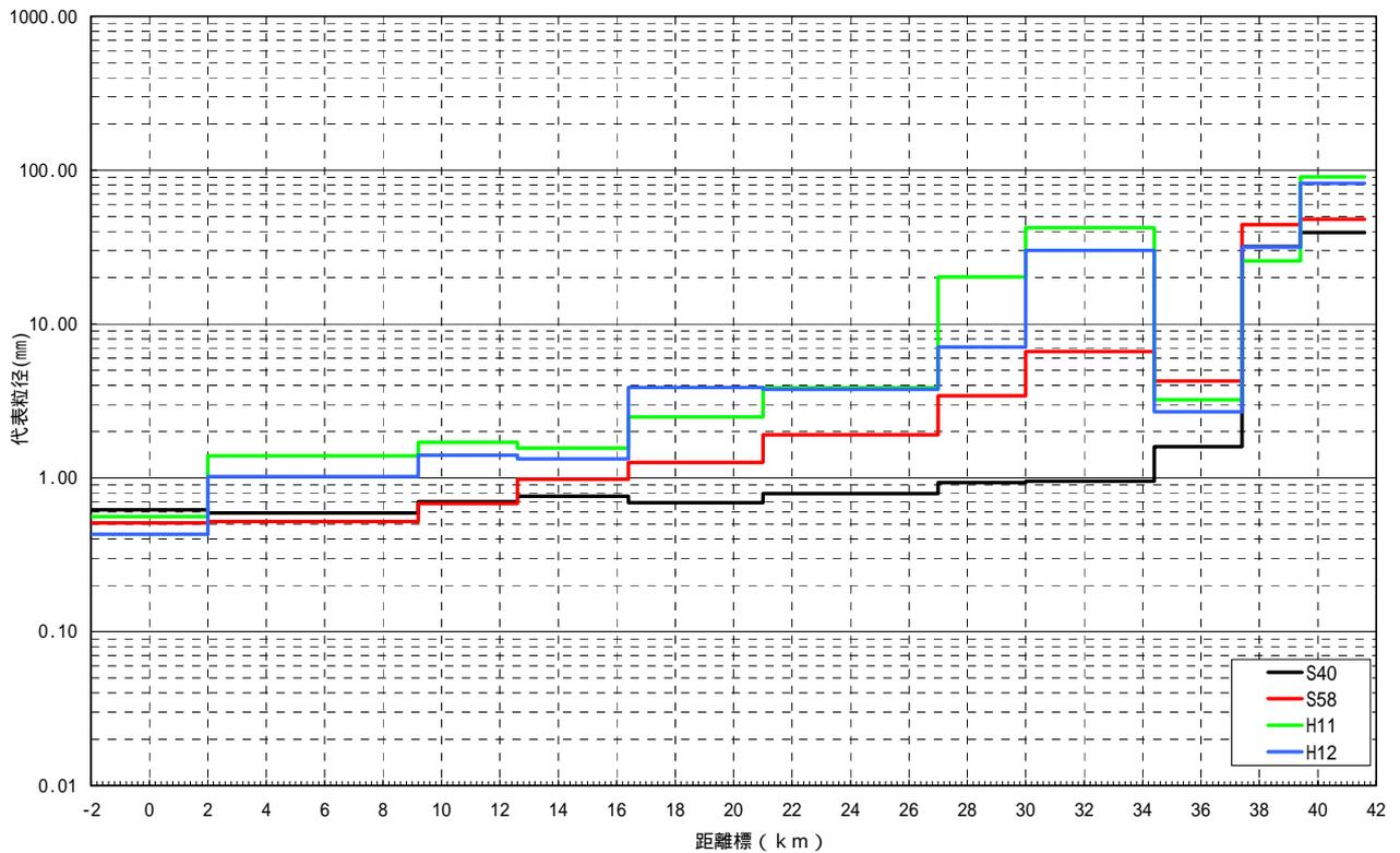
図 8-7 代表粒径(60%粒径)の経年変化(縦断面図)
