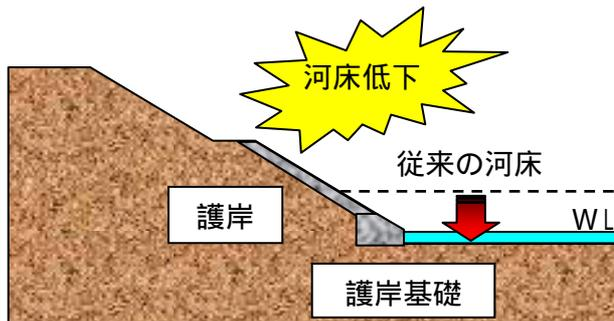
矢作川は、砂利採取等により河床が低下したことで、直接洪水が護岸基礎にあたる現象が発生している。そのため、護岸基礎の洗掘を防ぐために護岸の継ぎ足し工事が行われている。
