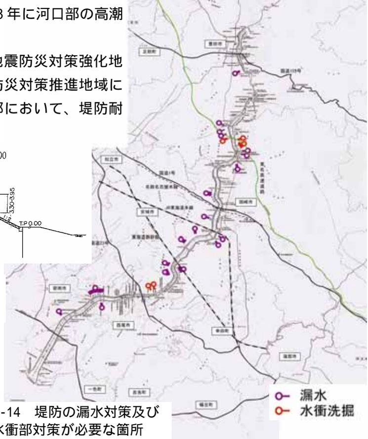
図 4-14 堤防の漏水対策及び水衝部対策が必要な箇所
