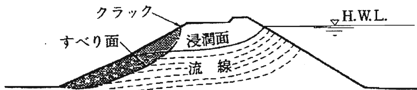
図2 堤防の浸透破壊の機構
