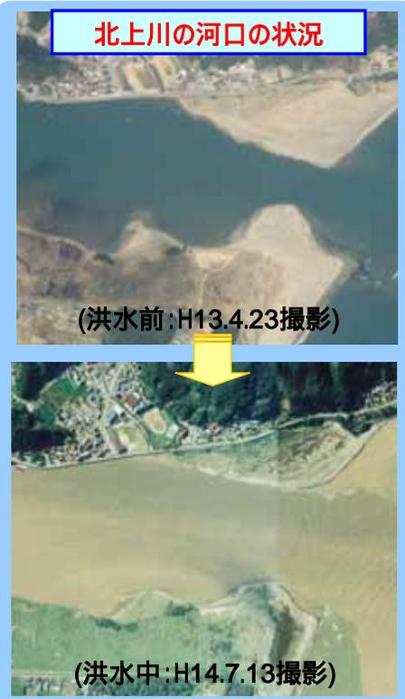
北上川の河口部では、砂州が発達するものの、洪水時には砂州の一部がフラッシュされ、河口閉塞が顕著ではない。今後も継続的にモニタリングを実施。
