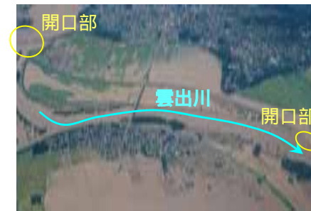
開口部の浸水状況(H5洪水)
