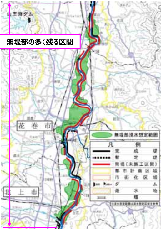
中流部の無堤状況
