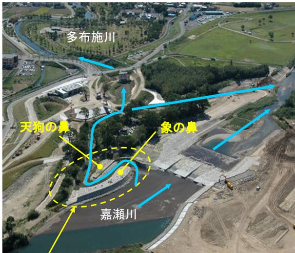
象の鼻、天狗の鼻の間を逆流させ、流れを弱めて土砂の沈降を図り、佐賀城下を含む左岸地区へ分派
