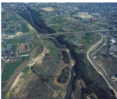
▲尼寺林（水害防備林） 洪水時の水の勢いを弱め、土砂を捕捉する役割を有する
