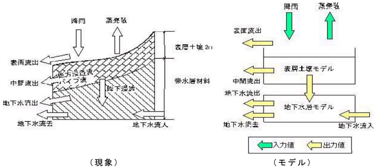
図 浸透域のモデル化の概念図
