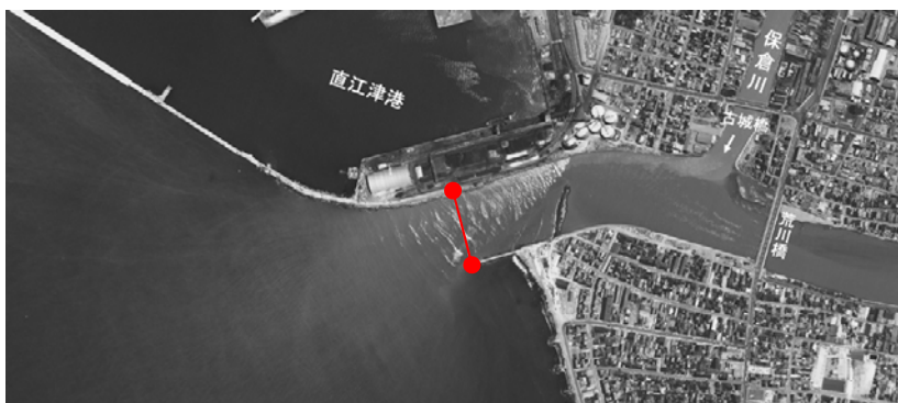
図3-1 昭和46年河口部砂州の堆積状況
