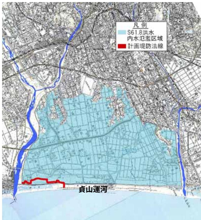
▲昭和 61 年 8 月洪水時の内水氾濫区域
