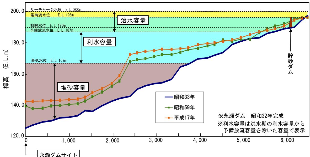
図5-3 永瀬ダムの堆砂縦断図（物部川本川、最深河床）
