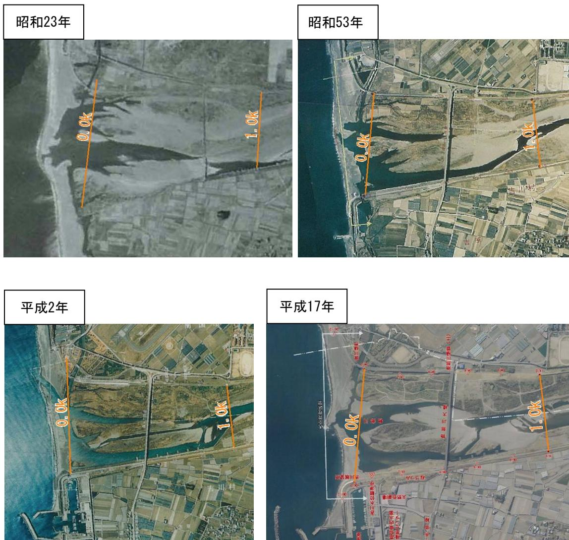
図3-1 河口砂州の形状の経年変化
