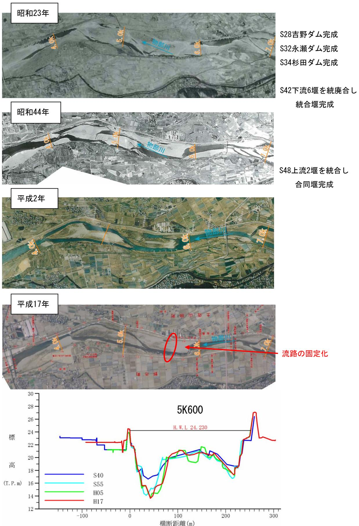
図2-6(2) 流路の固定化に伴う横断形状の経年変化 (3.5k~7.0k)
