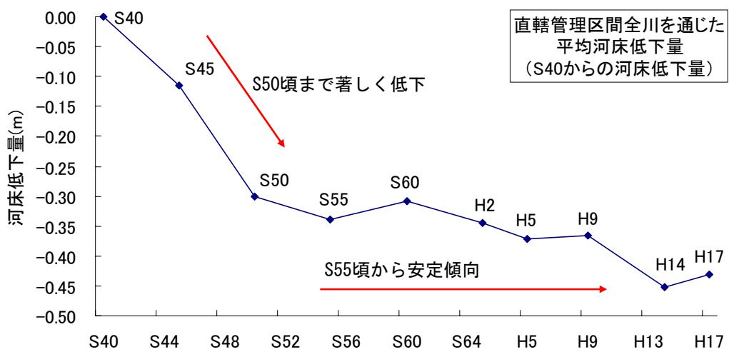
図2-1 物部川の平均河床高変動傾向
