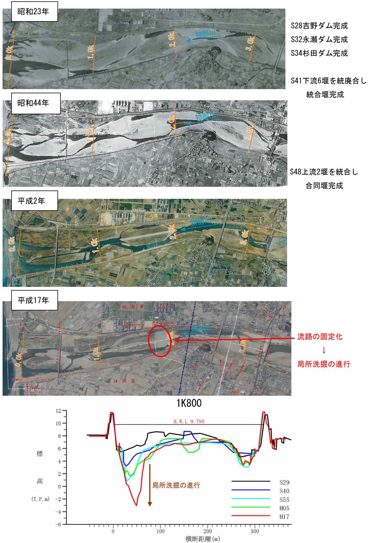
図2-6 流路の固定化に伴う横断形状の経年変化 (0.0k~3.5k)
