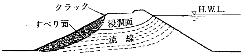
図2 堤防の浸透破壊の機構
