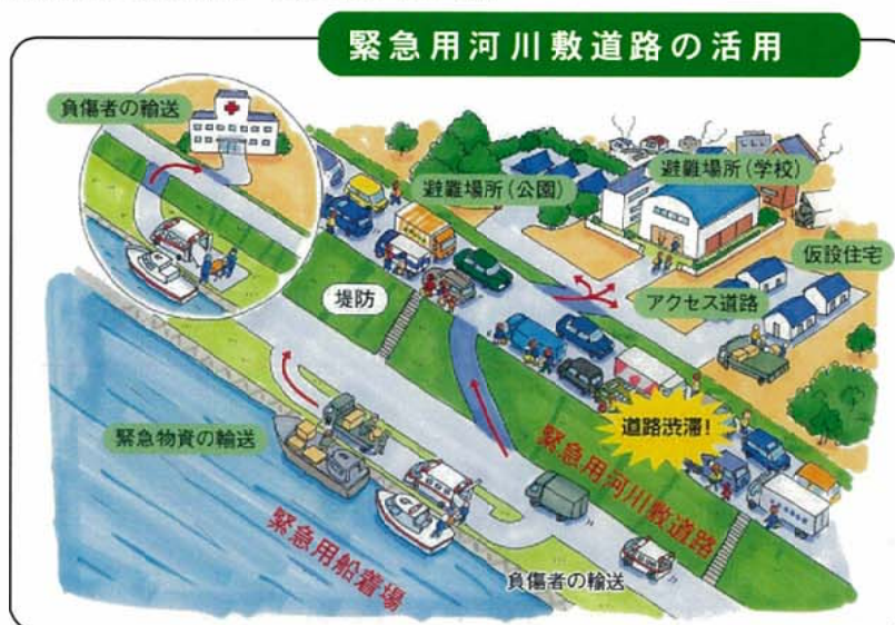
図-9.4.2 緊急用河川敷道路の活用
