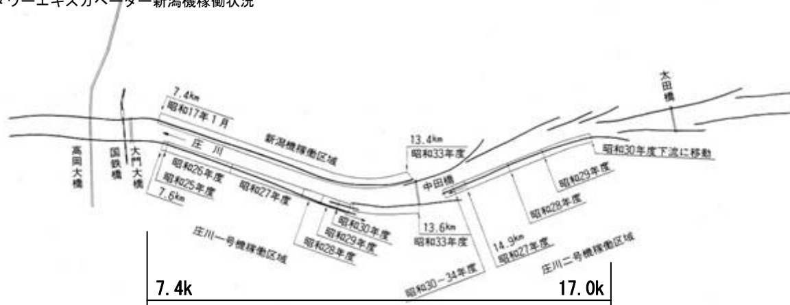
タワーエクスカーベーターによる掘削範囲
