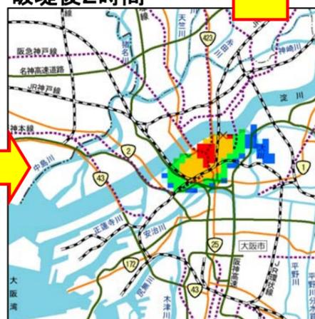
破堤直後から3mを超える浸水エリアが生じ、すぐさま浸水が拡大していく
