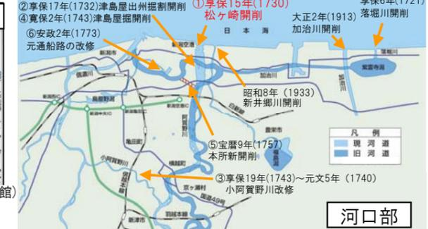
大正2年8月の大洪水・木津切れを機に大正4年に直轄事業として改修工事に着手。これにより、現在の河道が形成
