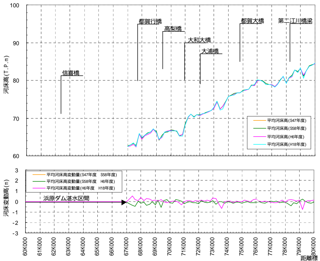
図 2-1(4) 低水路平均河床高縦断面図(上)、河床変動縦断面図(下)(江の川：60K000～80K000)
