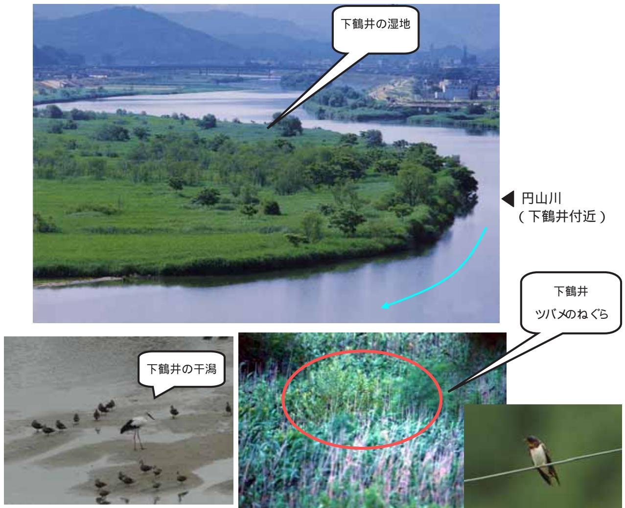
野上地区は、平成 12 年に河積確保の観点から高水敷を年平均水位に切り下げて、湿地再生を目指したものである。何度かの出水を経験し、年平均水位で切り下げた湿地は陸地化する傾向にある。
