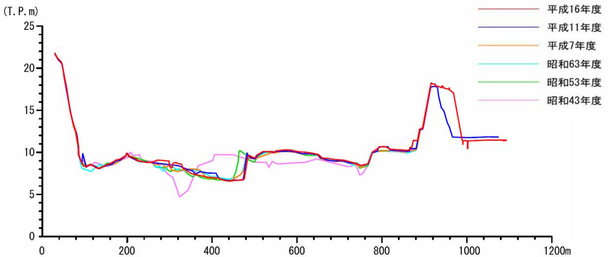
図 2-7 経年変化横断面図(旭川)
