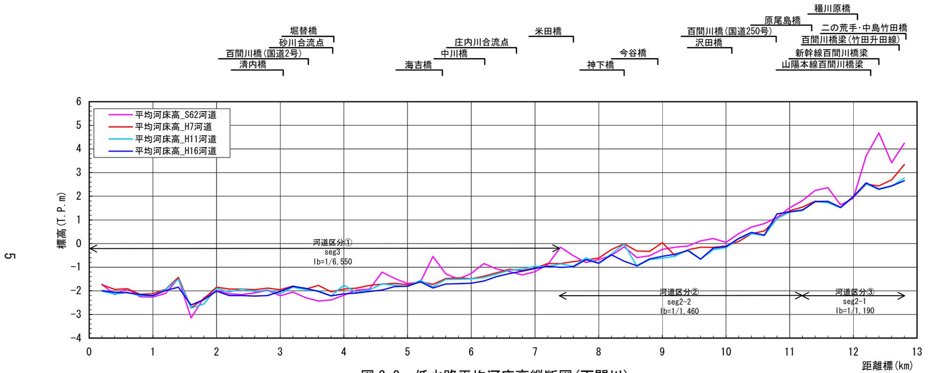
図 2-3 低水路平均河床高縦断図(百間川)
