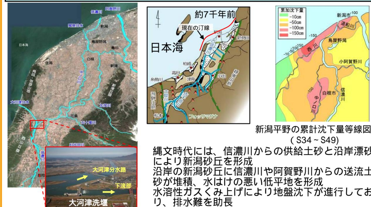
新潟平野の累計沈下量等線図 (S34~S49)
