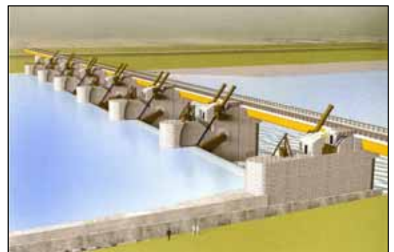
図 4-42 新可動堰イメージパース (出典：信濃川河川事務所資料)
