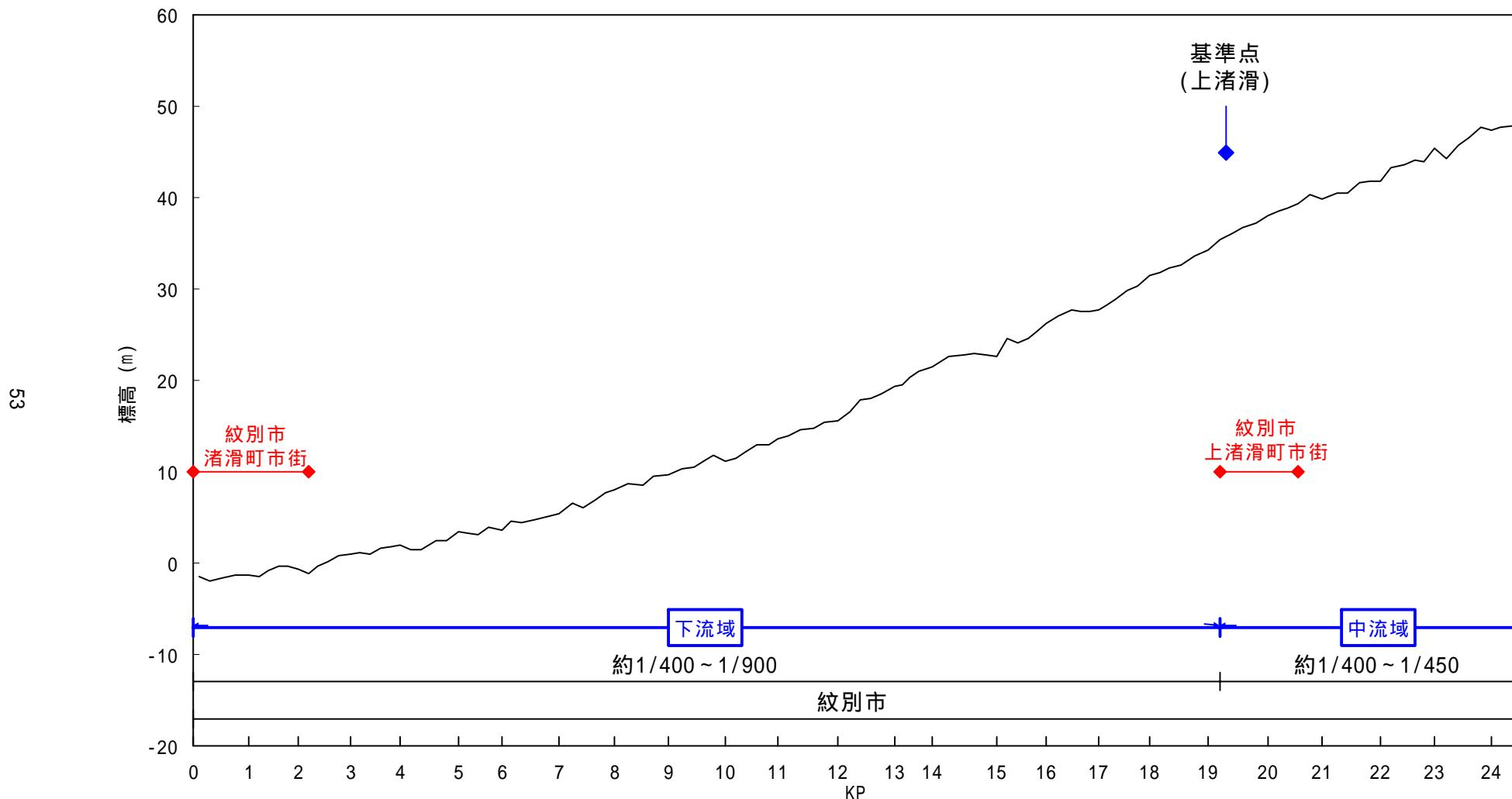
図 8-1 渚滑川水系 渚滑川 河床高縦断図 (直轄管理区間)
