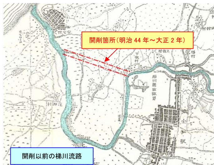
図 4-2 下牧地先と鶴ヶ島地先の「川切り」
