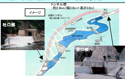
運用後の年間流入土砂量の8~9割は排砂バイパスにより下流に流下したと推定
