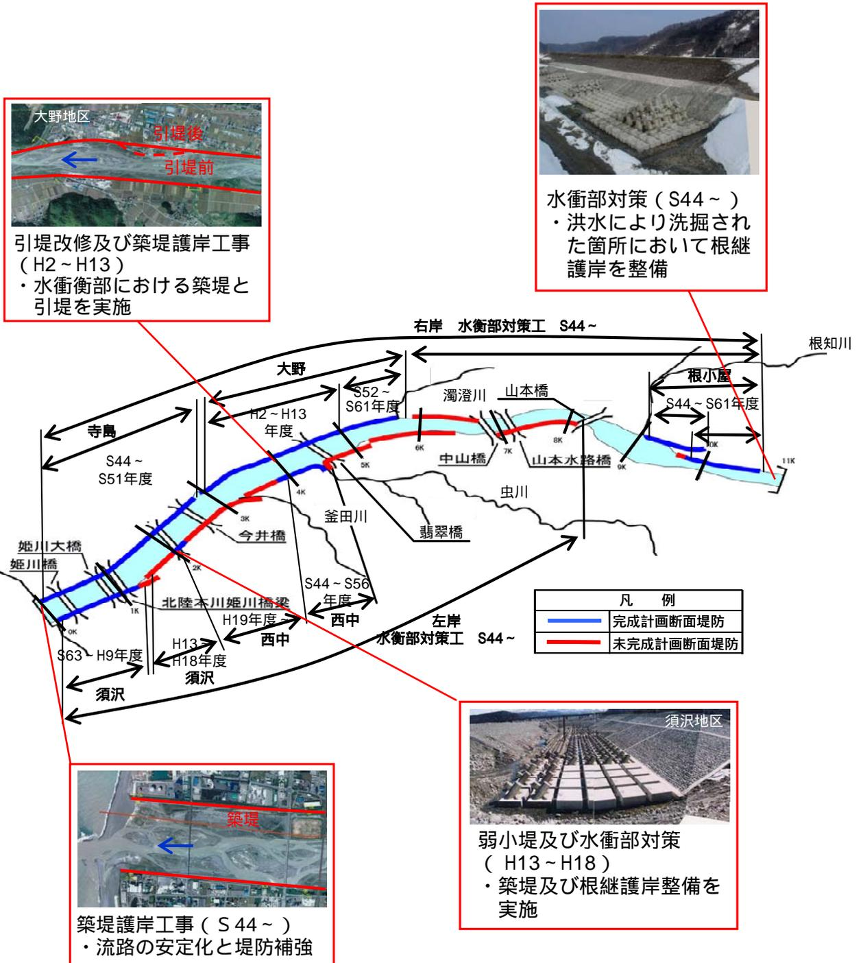
図 4-3 下流部での治水対策
