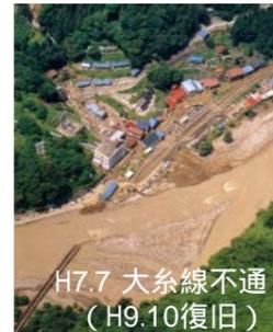
H7.7 河岸洗掘による破堤状況
