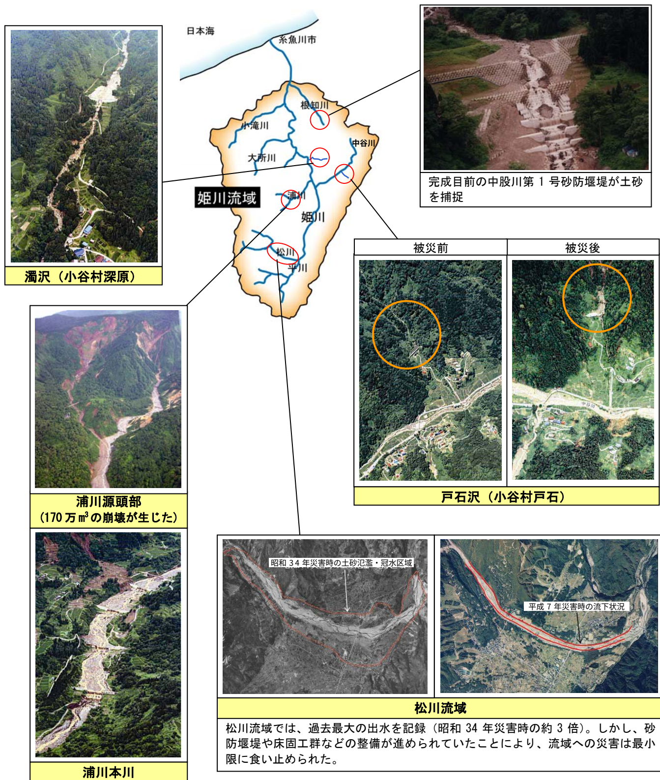
図 1 1 砂防堰堤の効果 (平成7年7月洪水)
