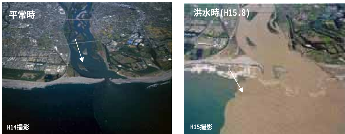
図 4-14：洪水時の砂州流出状況
