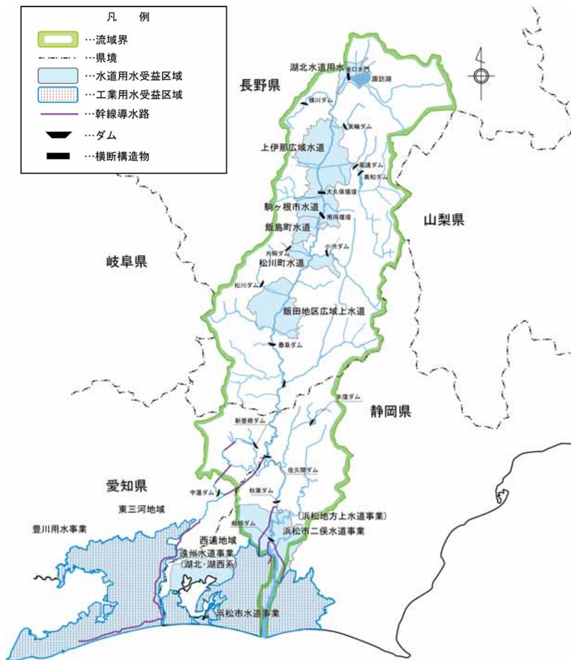
図 3-2 天竜川流域の水資源供給区域図 (主な水道水及び工業用水)
