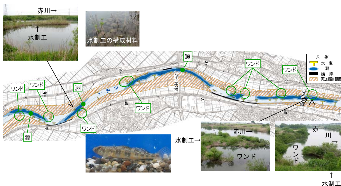
4k～8k 付近の水制工の配置状況
