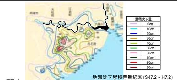
地盤沈下累積等量線図 (S47.2 ~ H7.2)
