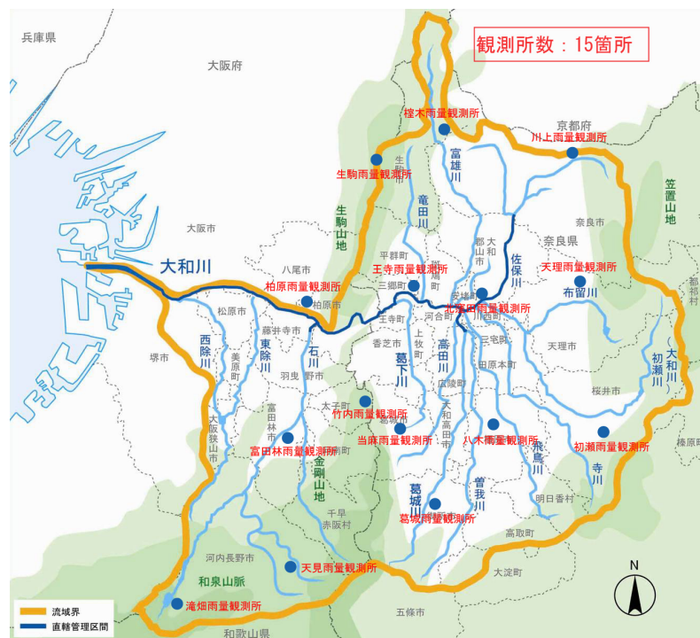
図 9.3 大和川河川事務所が設置しているテレメータ雨量観測所
