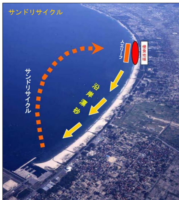
図 8.5 海岸線保全のためのサンドリサイクルの実施
