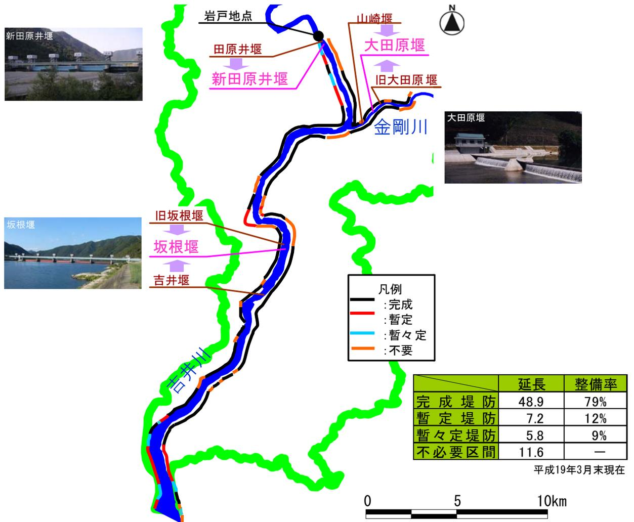
平成7年より、千躰地区の流下能力の解消として旧堤撤去や河道掘削を、堤防高、堤防幅が不足している乙子地区で築堤・樋門の整備を、九幡・西幸西地区の高潮被害などを防ぐため、堤防整備とあわせて耐震対策を行っている。
