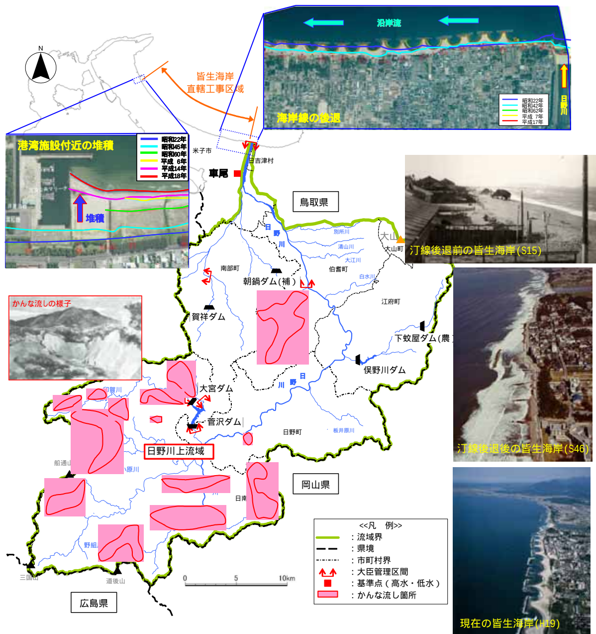
図 8.4.3 かなな流し実施箇所と海岸線の変動状況
