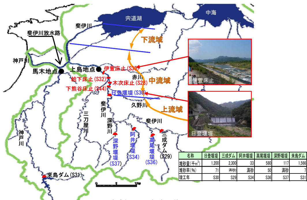
図 8.3.3 砂防堰堤の堆砂の状況
