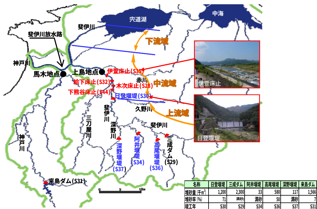
図 8.3.3 砂防堰堤の堆砂の状況
