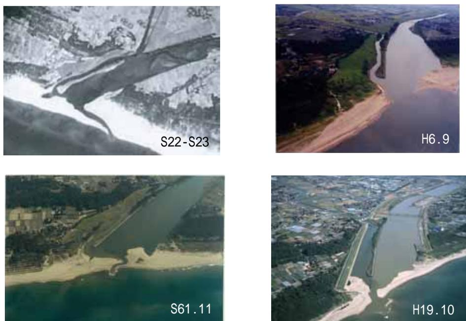
図 4.3.1 河口砂州の変遷図
