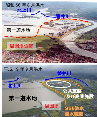
一関遊水地における出水時の状況比較。H14.7 洪水・H19.9 洪水では周囲堤完成により浸水被害が軽減されている。
