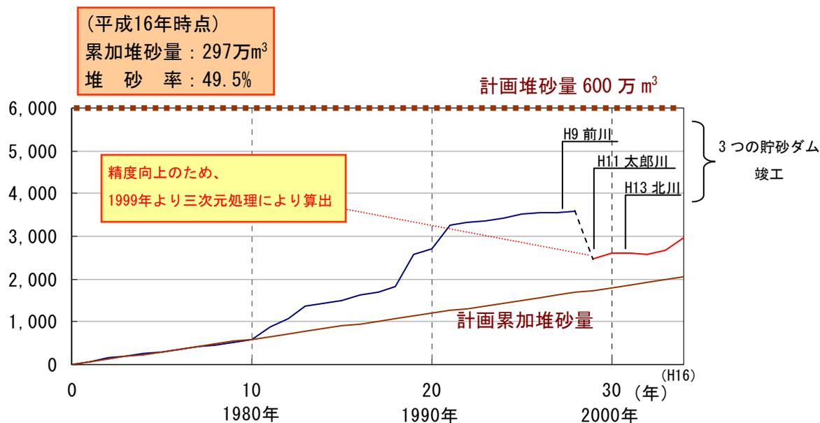
図 8-3-2 釜房ダム堆砂状況
