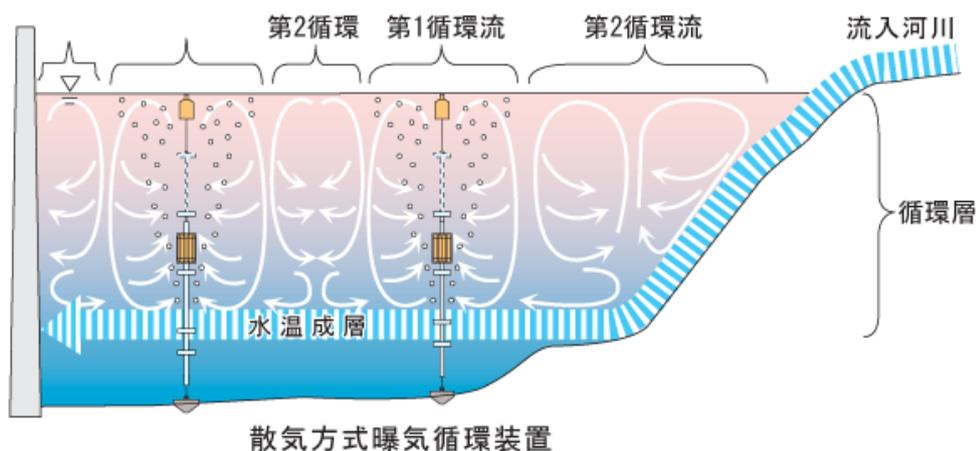
**間欠式空気揚水筒と散気方式の曝気循環装置との相違点**
